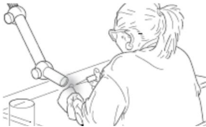
برداشت ذرات به جا مانده از مراحل قبلی (لحیم کاری، تعمیر): هدایت هود به منطقه کار
