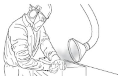
کار بر روی سطح قطعه: اطمینان از نزدیکی هود به سطح کار
